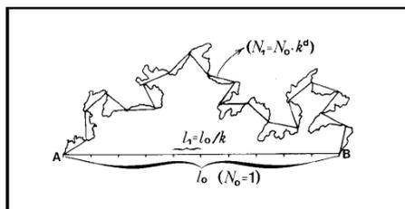
Figure 17. Arpentage d'une courbe fractale
