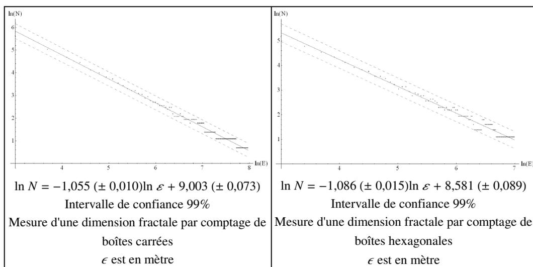
Figure 24. Comparaison entre une mesure de dimension fractale par comptage de boîtes carrées et une mesure de la dimension fractale par comptage de boîtes hexagonales
